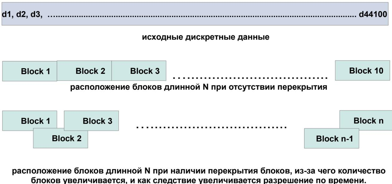
Рис. 2.2.1 Различная конфигурация расположения блоков, при расчете ДПФ. (для большей наглядности перекрытые блоки смещены по вертикали)
