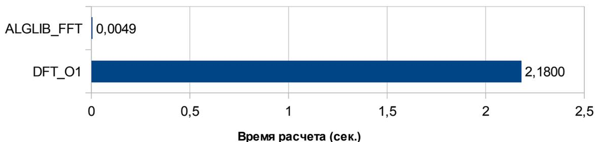
Рис. 3.6.2 Временная диаграмма расчета спектра. DFT\_O1 — наша реализация ДПФ и ALGLIB\_FFT — расчет при помощи библиотеки ALGLIB ver. 2.6.0 методом БПФ.
